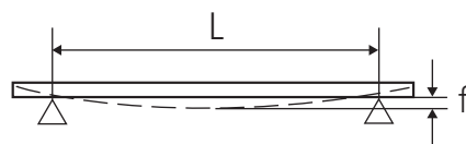
Schéma 1 : calcul des charges, f = déformation maximale, L = longueur
