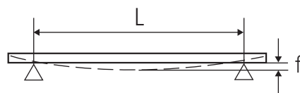
Obrázek 1: Výpočet zatížení, f = maximální průhyb, L = délka
