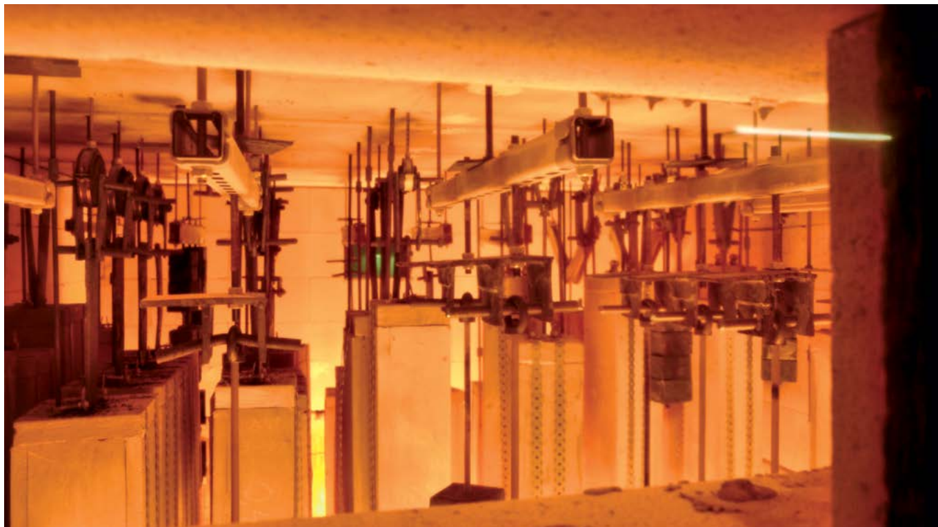
■ Brandtest Walraven Bevestigingssystemen
