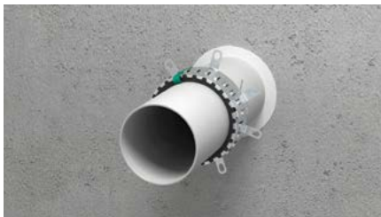
4. Sluit de manchet door de strip van binnen naar buiten door de tweede opening te steken en terug te buigen.
