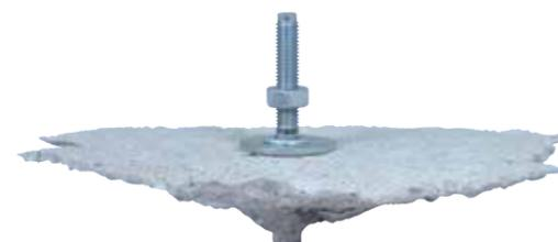
Dividimos el hormigón en "agrietado/fisurado" y "no agrietado/sin fisurar", basándonos en la compresión de la zona de tracción/tensión. (Compresión es desde arriba y tracción es desde abajo, definidas como opción 1 y opción 7 respectivamente en ETA).
