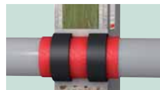
Inbyggd lösning i lätta skiljeväggar ≥ 100 mm
