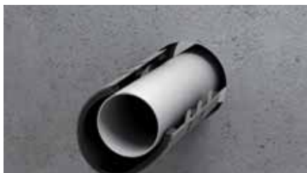
1. Svep manschetten runt röret
