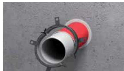
3. Manchetgrootte kiezen (bij moeilijke inbouwsituaties tot max. 3 afmetingen groter te kiezen)
