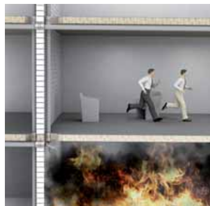
3. De Pacifyre® MK II Brandmanchet wordt geactiveerd en de aanwezigen hebben tijd om te vluchten
