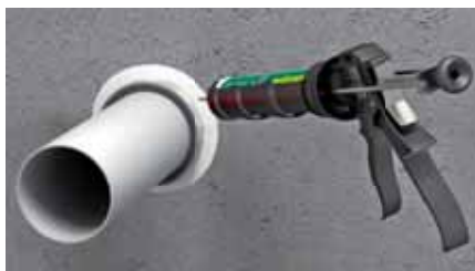
2. Plaats rotswol als rugvulling en vul 25 mm in de diepte met Acryl of Siliconen Kit
