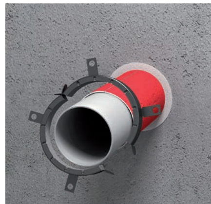
3. Selecciona la medida de collarín correcta (en situaciones problemáticas, está permitido usar hasta 3 medidas superiores)
