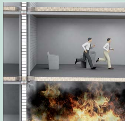
3. BIS Pacifyre® MK II Protipožární manžeta se pustí do práce a obyvatelé mají čas odejít do bezpečí
