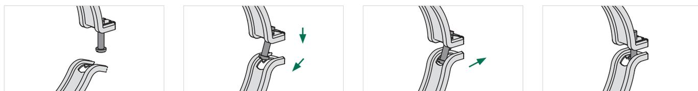
$D \geq 450$  : fermeture 2 écrous à tête hexagonale
